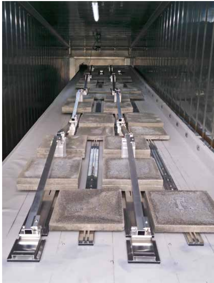
Aufbau im Klimacontainer von PMT. Die linke Schiene ist über eine Kraftmessung am Testdach angebunden. Die rechte Schiene ist nicht angebunden. Der Test soll zeigen, ob sich die rechte Schiene bewegt und wie viel Kraft man bei der linken Schiene benötigt, um die Bewegung zu unterdrücken.
