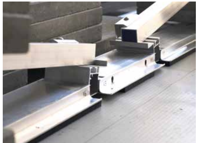
Die gemessenen Kräfte waren geringer als die theoretisch vorhergesagten. Einen Grund dafür sieht Peter Grass in der Flexibilität der Verbindungen des Klicksystems.
